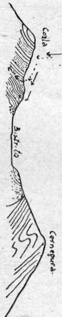
Profil geologic — Cozla-Cernegura, direcția N.—S. Săgeata plină, prima alunecare. Săgeata întreruptă, noua direcție de alunecare.
