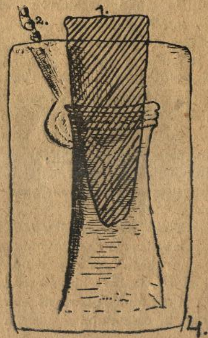
Pl. II. 1—2 Tipare de Toporașe de bronz (colecția autorului) 3, lipar de ciocan. Mărime \frac{1}{2} . 4, felul cum să așeze dopul de lemn 1, pentru a rămâne loc gol la turnare. 2, arată pe unde se turna bronzul.
